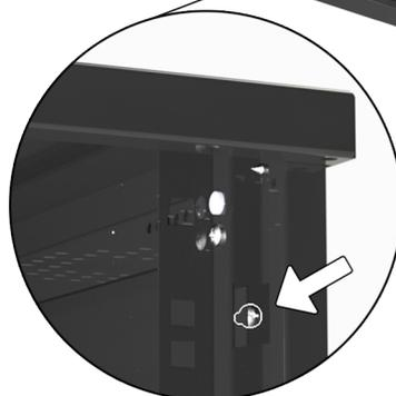
ENCAIXE AS LATERAIS NO PERFIL DO FUNDO DO RACK COM AS VENTILAÇÕES VIRADAS PARA BAIXO.
